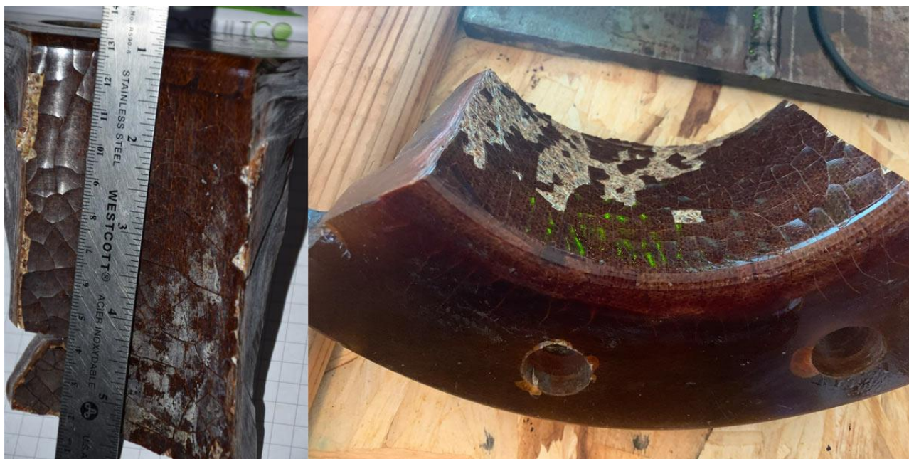
Рис. 4 Состояние внутренней поверхности и коррозия FRP
